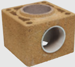
Если ваша печь не способна выдержать нагрузку модульного дымохода, вам потребуется только установить соединение с заранее подготовленной втулкой. Если при сборке высота соединения неизвестна, отверстие можно сделать после того, как будет установлен собранный дымоход.
