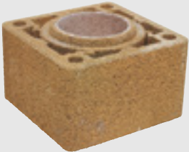
Дымоход Heda легко и быстро устанавливается, поскольку труба для топочного газа, изоляция и внешняя оболочка составляют единый компонент. Здесь показан стандартный элемент дымохода.
